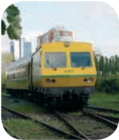
Drezyna EM 120 do pomiarów geometrii torów
