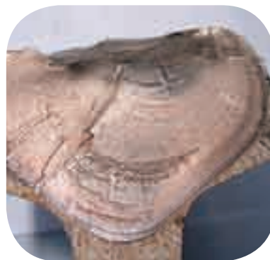
Wykrywanie wad wewnętrznych w szynach za pomocą ręcznego stanowiska diagnostycznego
